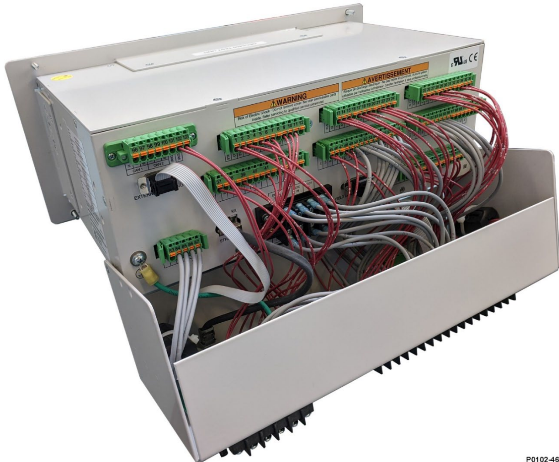
Figura 15-5. Cableado de placa de transición a DECS-450
