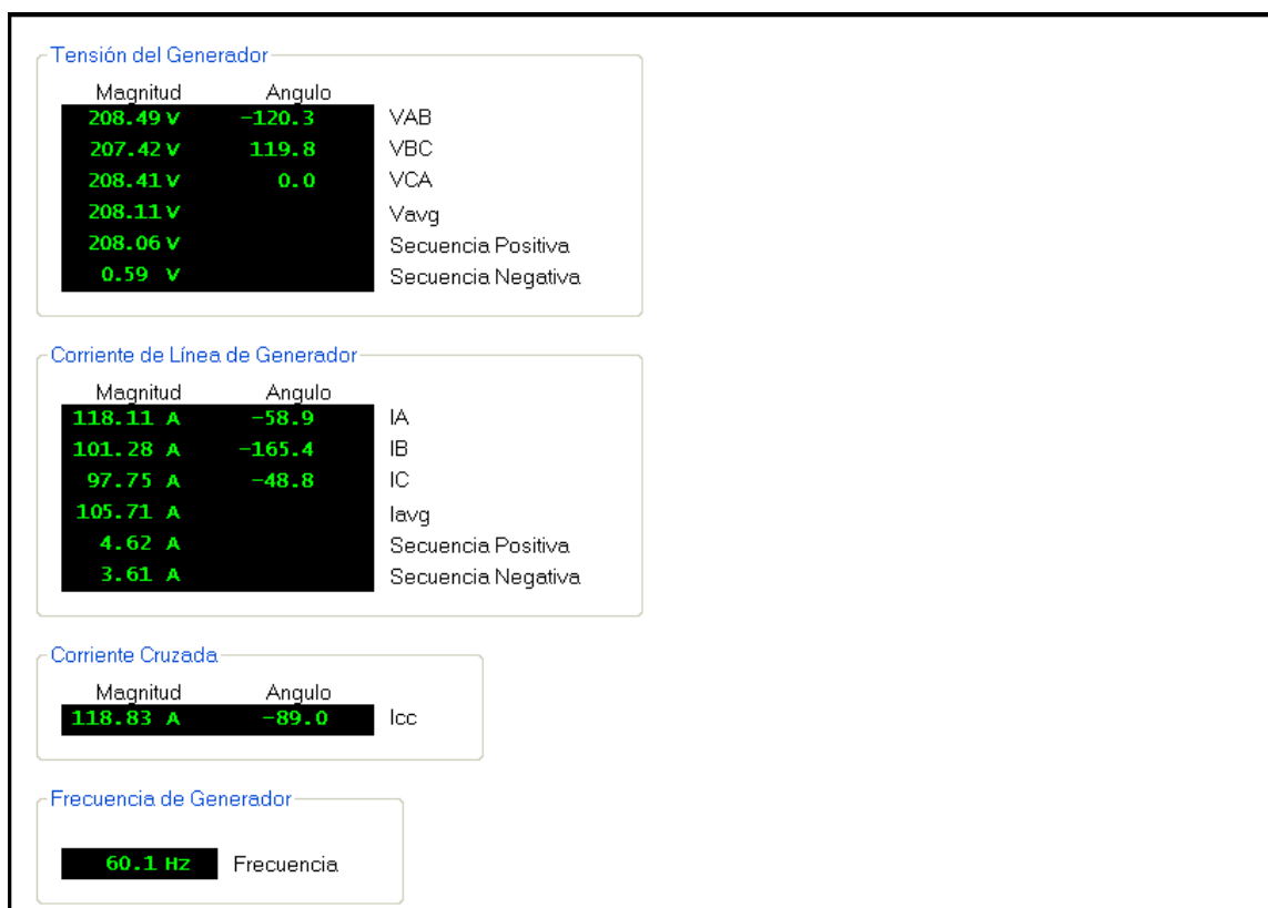
Figura 13-2. Medición de los Valores Primarios del Generador
