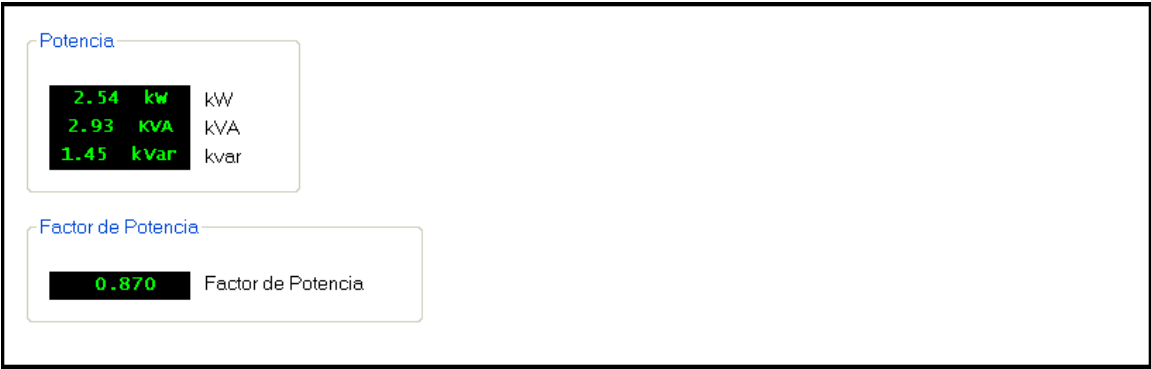
Figura 13-3. Valores Primario de Potencia
