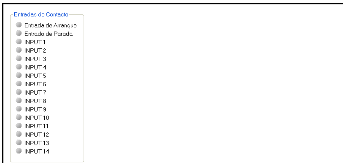
Figura 13-14. Pantalla de Indicación de Estado de Entradas de Contacto del DECS-250
