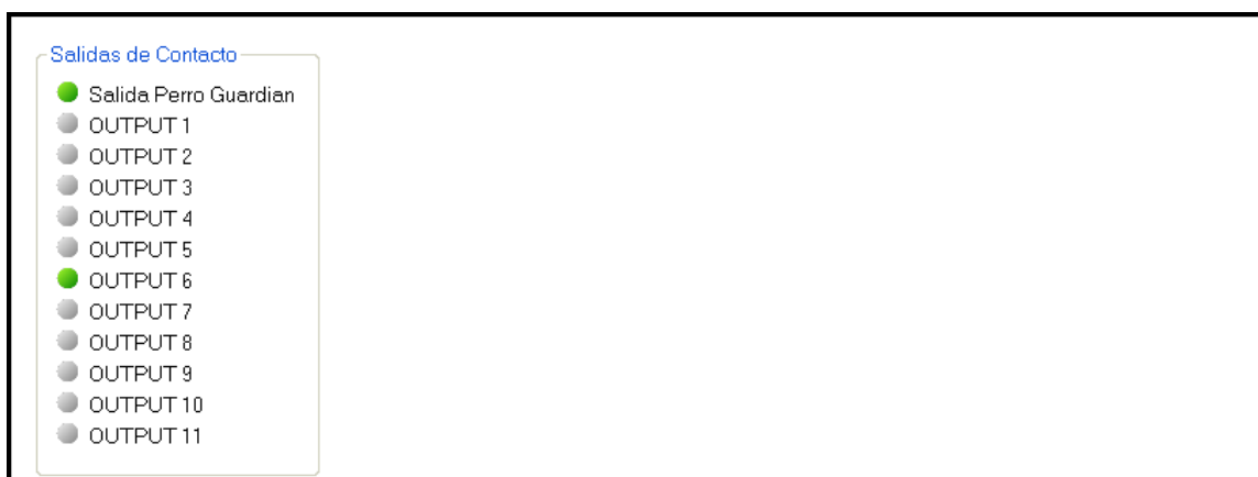
Figura 13-15. Pantalla de Indicación de Estado de Salidas de Contacto del DECS-250N
