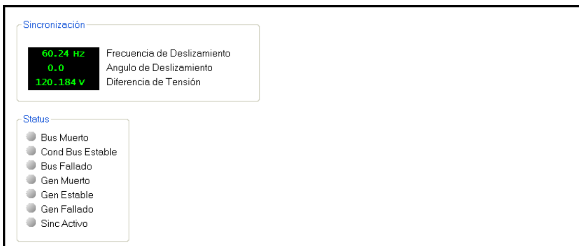
Figura 13-8. Medición de Valores Primarios de la Sincronización
