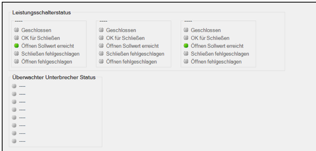
Abbildung 3-14. Messungs-Explorer, Status, Fenster Leistungsschalterstatus
