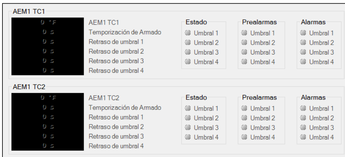
Figura 3-22. Explorador de medición, Entradas, Entradas analógicas remotas, Entradas AEM 1, pantalla de Entradas termocupla AEM 1
