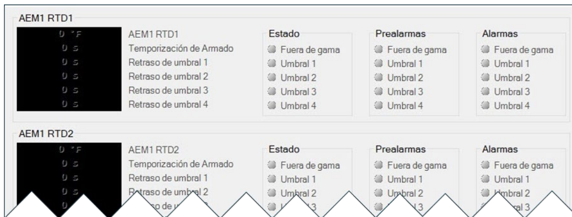
Figura 3-21. Explorador de medición, Entradas, Entradas analógicas remotas, Entradas AEM 1, pantalla de Entradas RTD AEM 1
