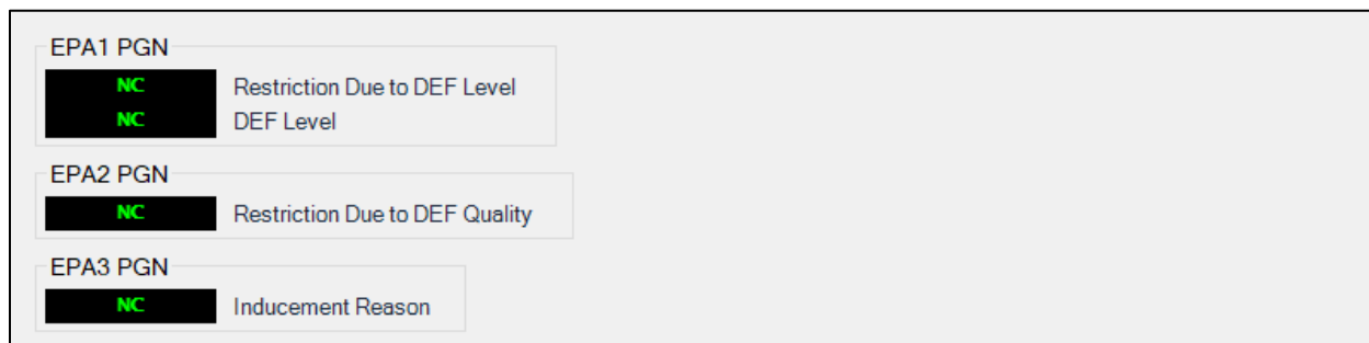
Figura 3-43. Explorador de medición, ECU J1939, pantalla de Estado de Deutz
