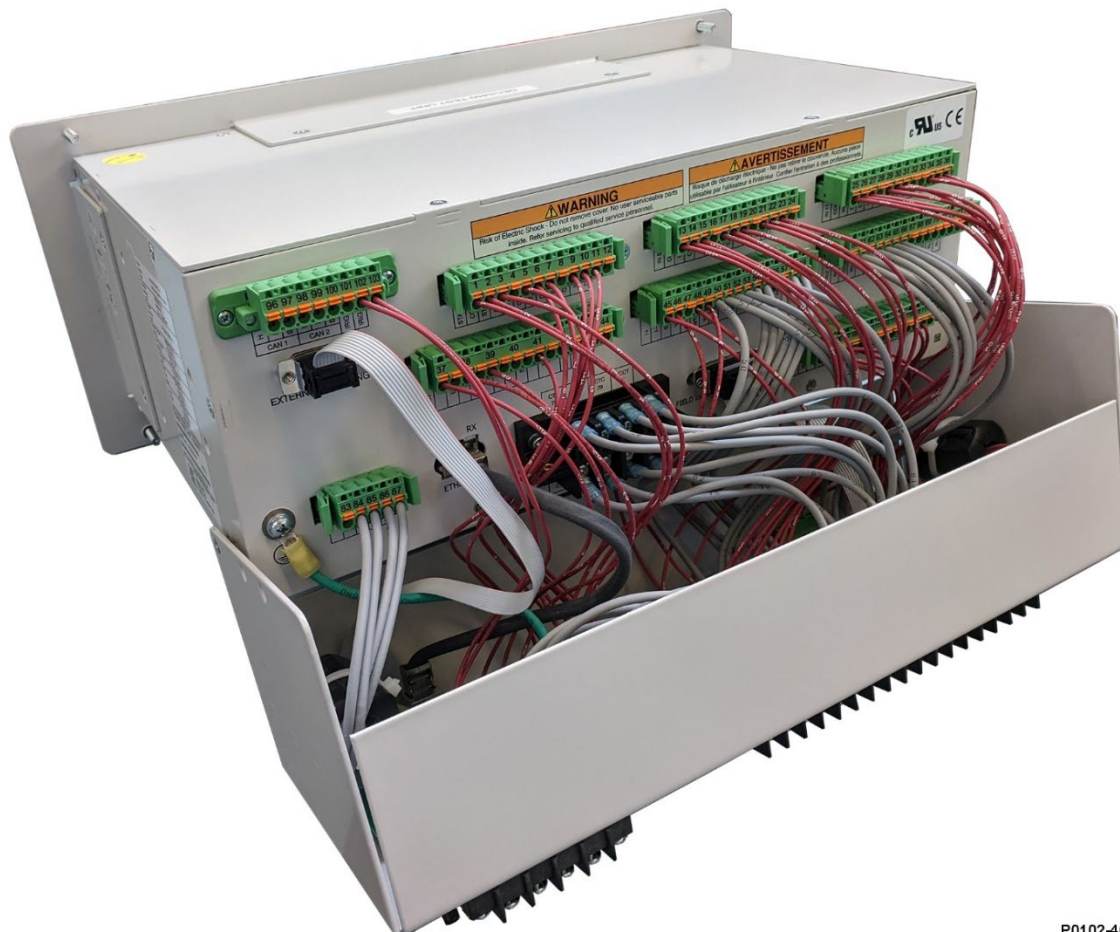
图 15-1. 过渡板接线符合 DECS-450 标准
