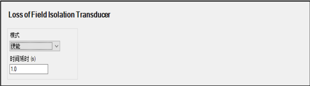
图 9-15. 励磁隔离变送器丢失设置
