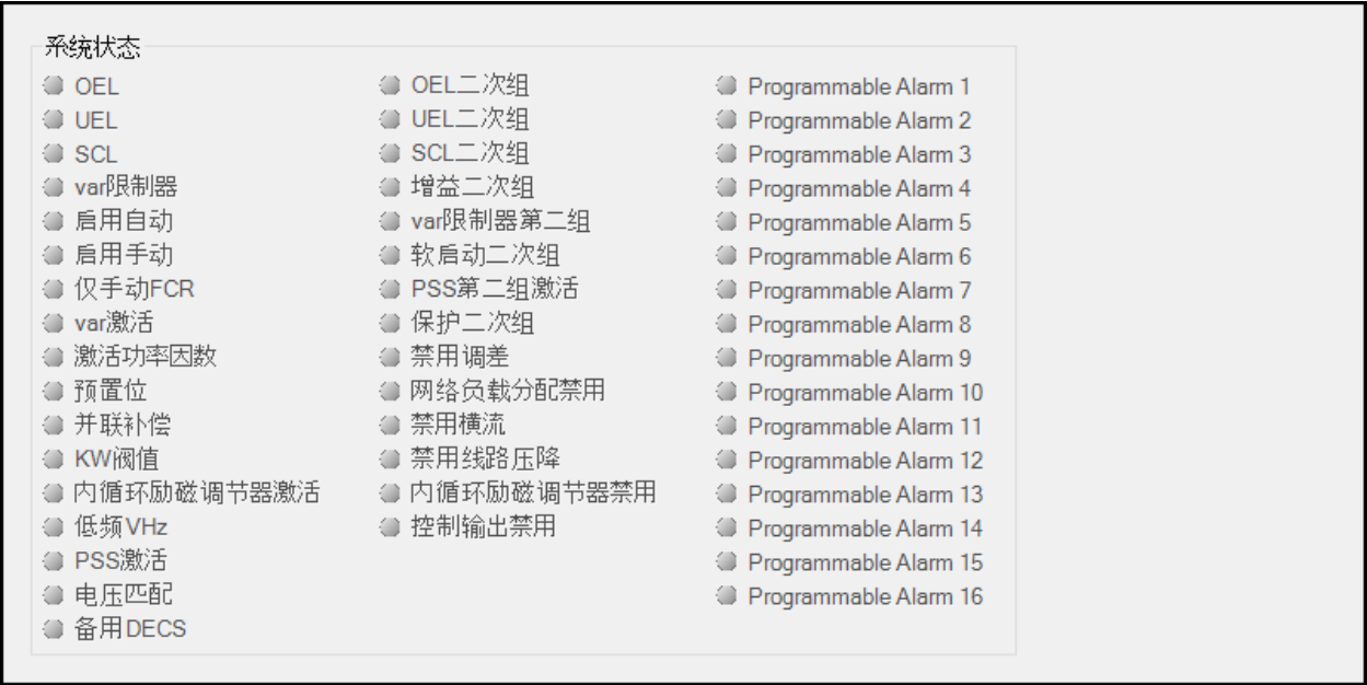
图 11-13 系统状态指示屏幕
