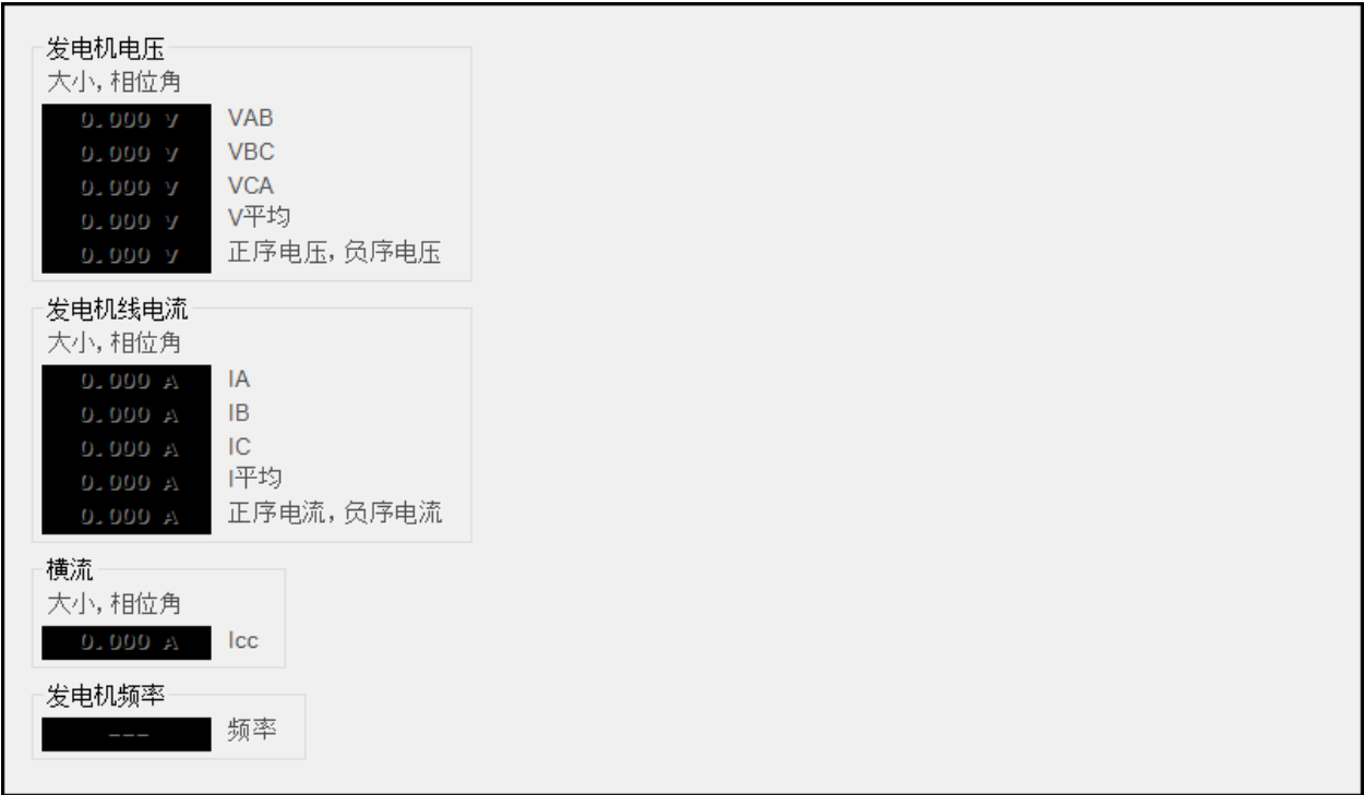
图 11-2 发电机实际值测量
