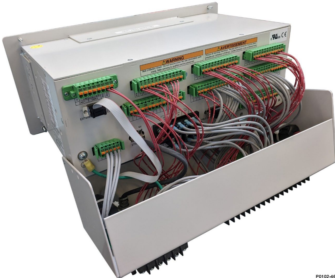
Figura 15-5. Cableado de placa de transición a DECS-450
