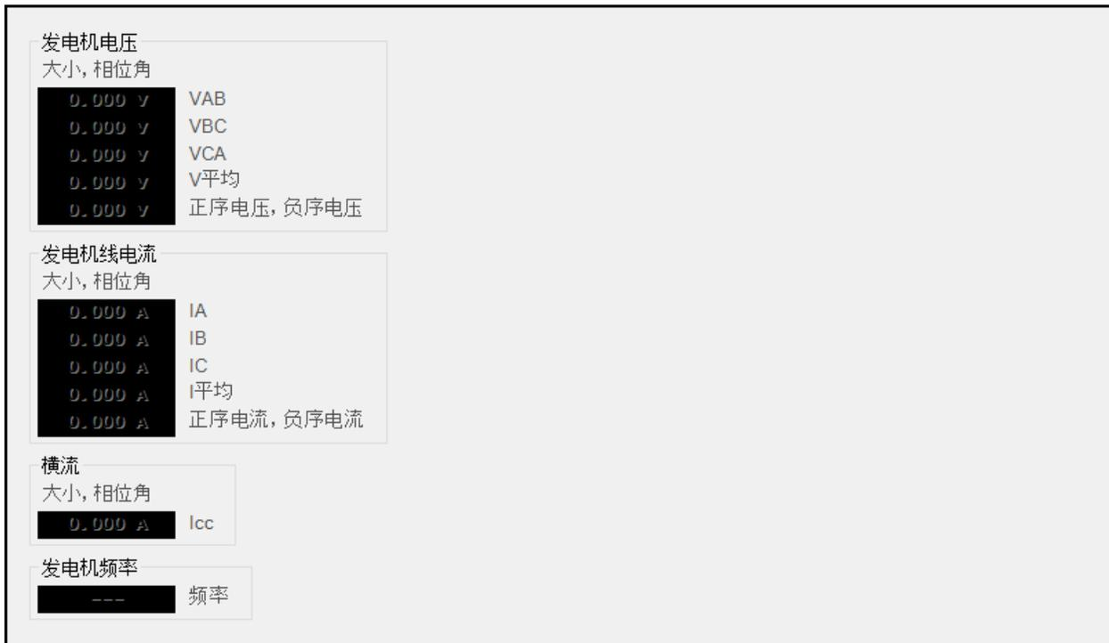
图 11-2 发电机实际值测量
