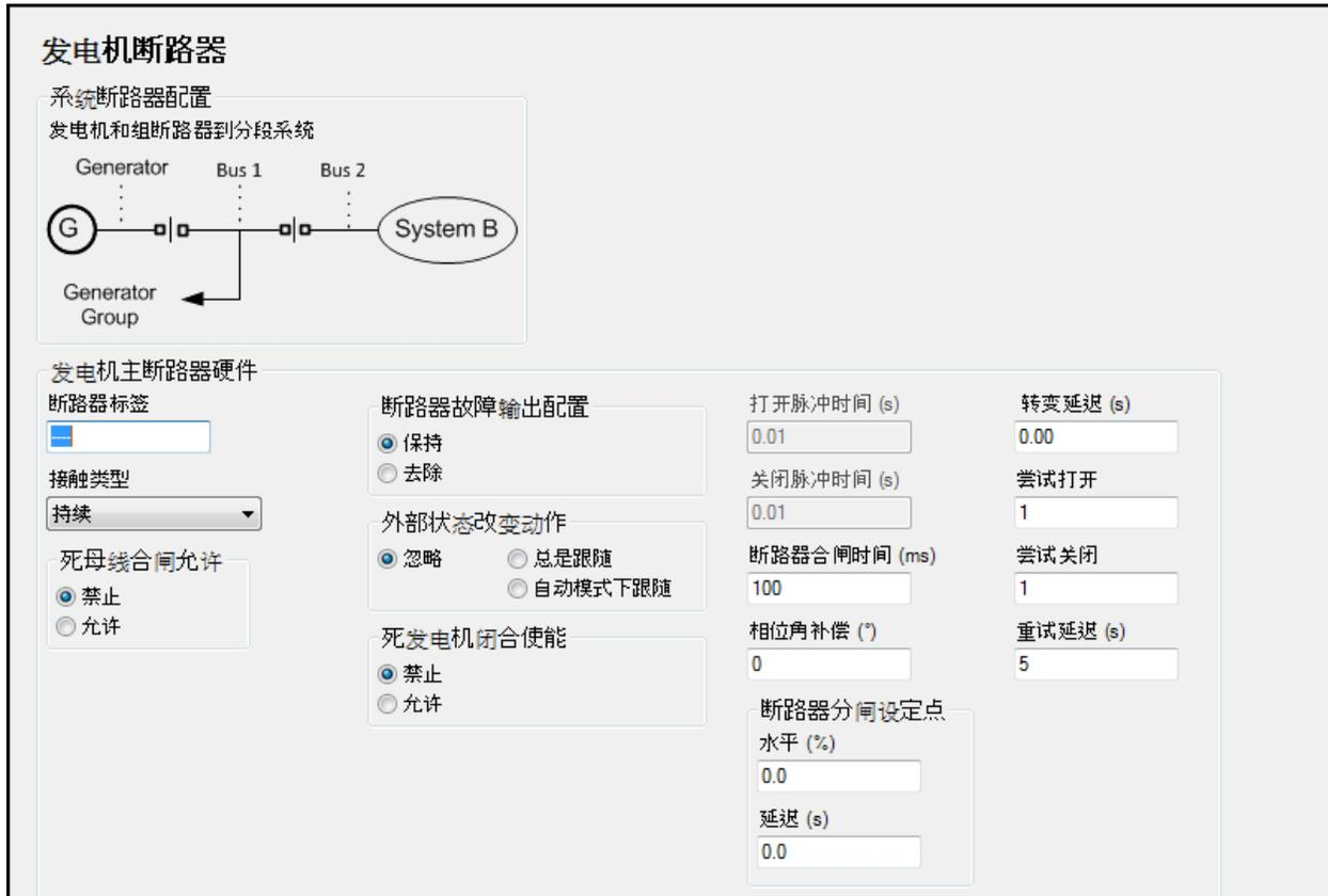
图 13-6. 设置资源管理器，断路器管理，断路器硬件
