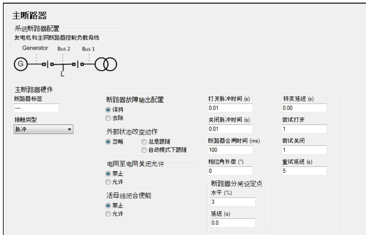
图 12-28. 设置资源管理器，断路器管理，断路器硬件，电网断路器界面
