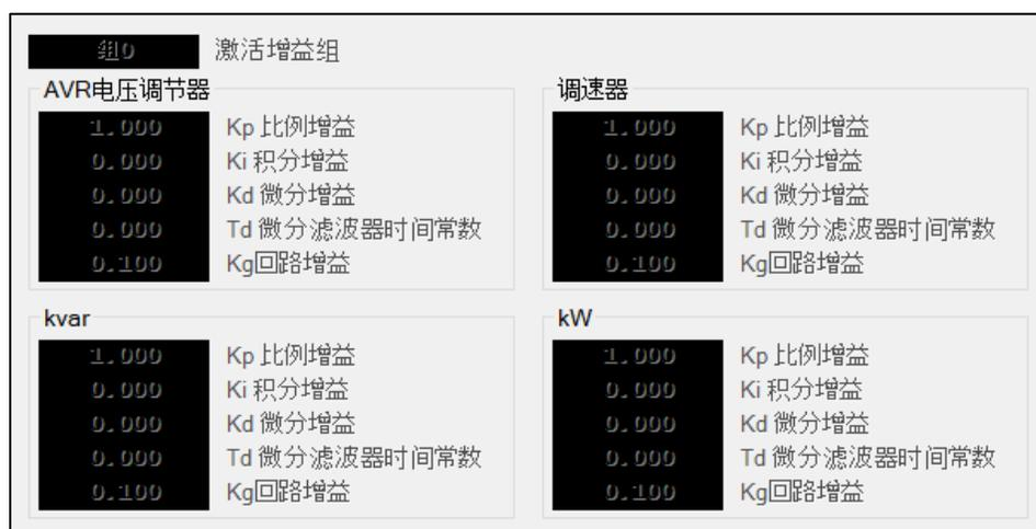
图 3-80. 测量资源管理器、诊断、PID 增益组
