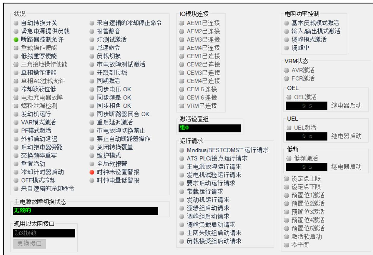
图 3-13. 测量资源管理器、状态界面（发电机和群断路器控制）
