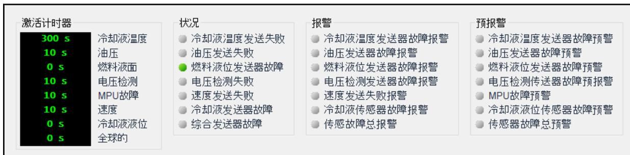
图 3-16.测量资源管理器、传感器故障屏幕
