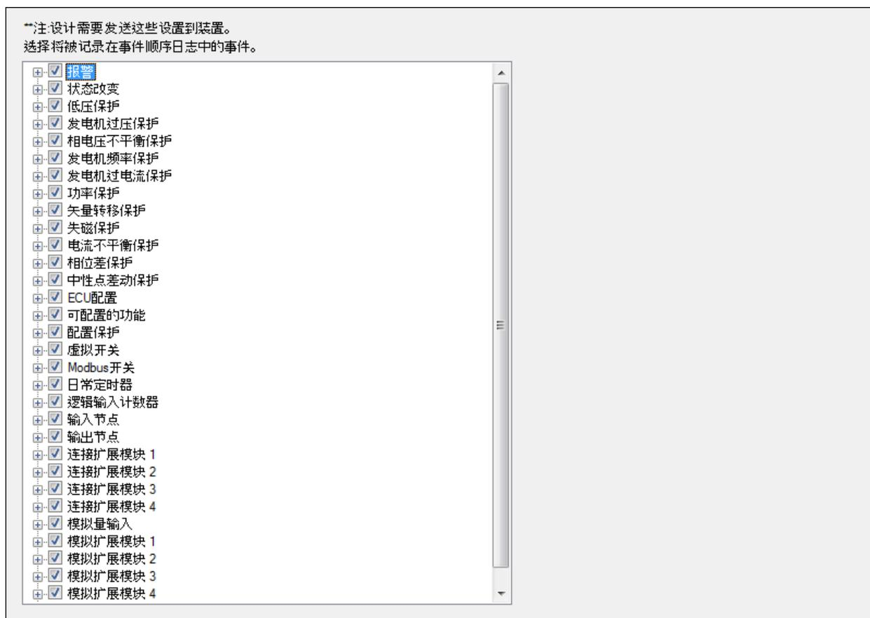
图 4-3. 设置资源管理器，报告配置，事件顺序设定
