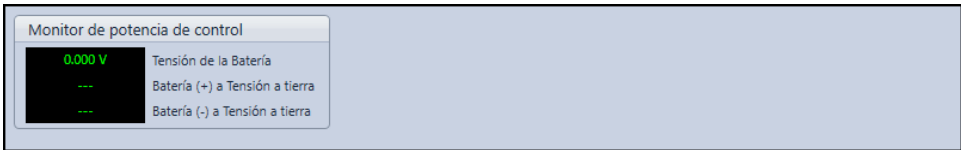
Figura 42-3. Pantalla de medición del Monitor de potencia de control
