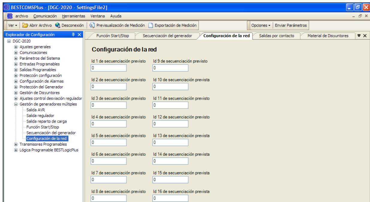
Figura 7-63. Explorador de Configuración, Gestión de Generadores Múltiples, Configuración de Red
