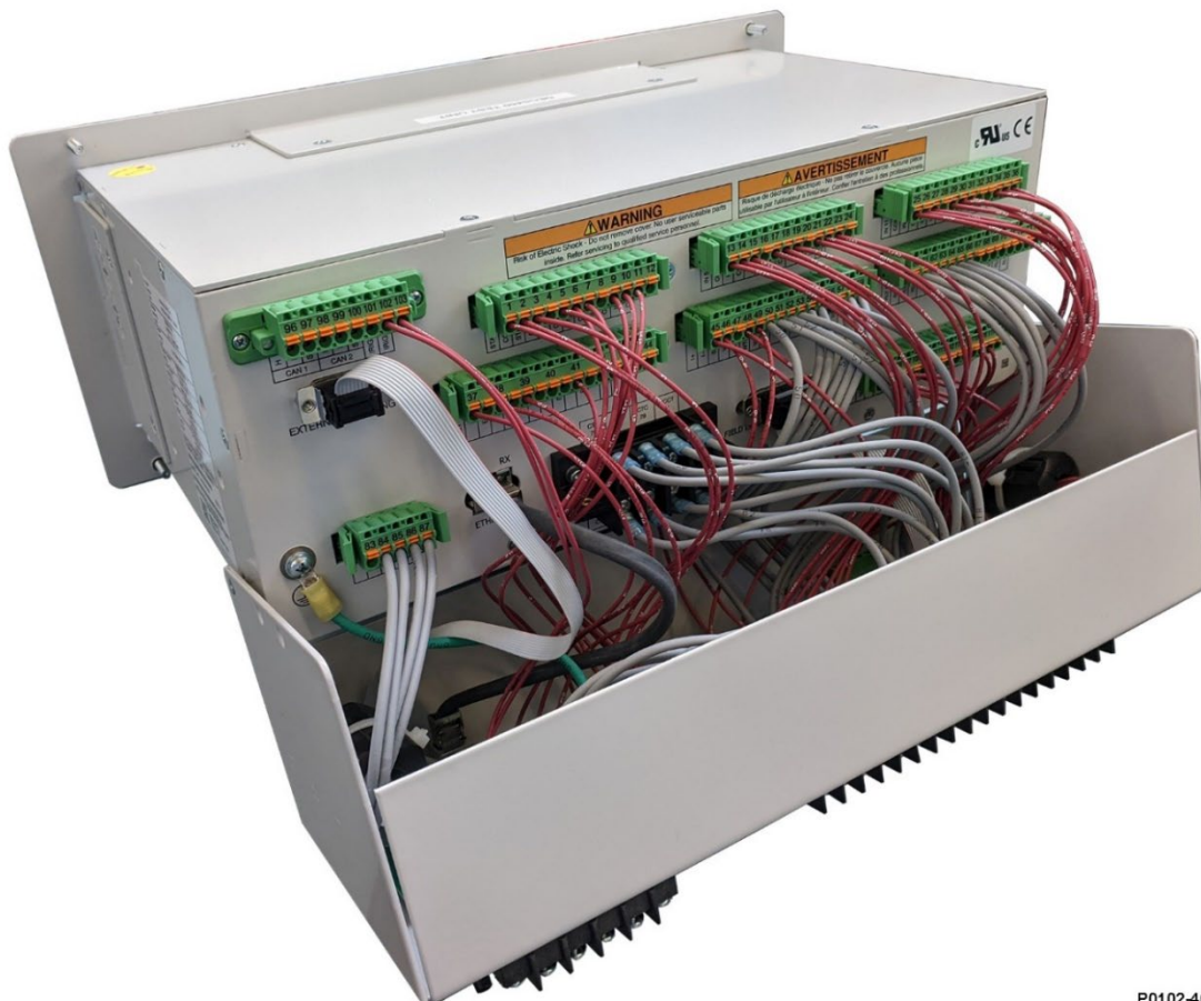
Abbildung 14-5. Verdrahtung der Übergangsplatte zu DECS-450R (DECS-450 abgebildet)
