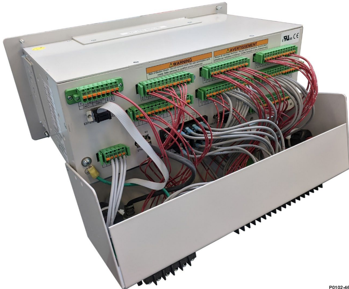
Figura 14-5. Cableado de la placa de transición a DECS-450R (se muestra DECS-450)
