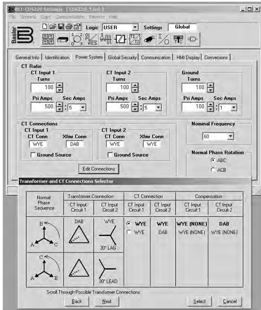
Figure 12 - BE1-CDS220 Setting Software
